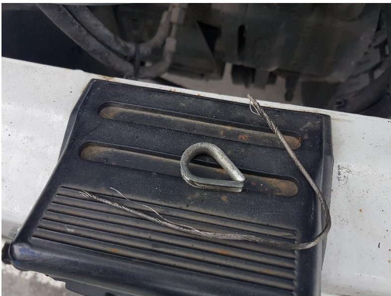
(Defektes Standgas-Seil – gerissen)
